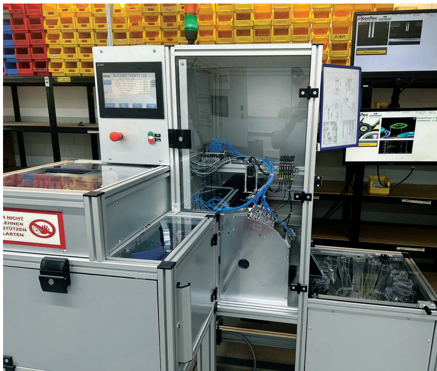
In der vollautomatischen Prüfstation werden hundertprozentige Prüfungen der Bauteile mit Chargen- und Nestbezug durchgeführt. © Hoffmann
